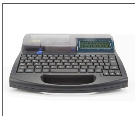
PROMARK T-1000 Märkmaskin T-1000 är idealisk för mindre produktion och kompletteringsmärkning på plats.
